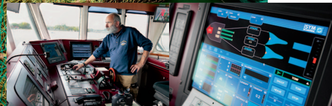
Hightech-Brücke: Was Kapitän Rolf Singer mit bloßem Auge nicht sieht, zeigen ihm die Monitore – auch die Position der beiden Netze (Bild rechts), die die „Clupea“ als moderner Twintrawler schleppen kann.
